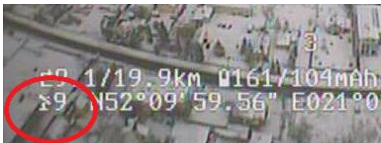
Rysunek 21 Ilość śledzonych satelitów systemu GPS. Im większa ilość satelitów, tym dokładniejszy pomiar położenia, prędkości oraz kursu modelu. Problemy z nawigacją GPS (łapaniem FIX-a) oraz małą ilością śledzonych satelitów mogą być spowodowane zakłóceniami np. od nadajnika AV, kamery lub innych elementów zestawu FPV.
