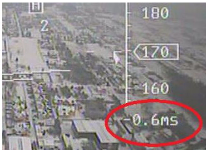
Rysunek 17 Tekstowy wskaźnik wznoszenia lub opadania modelu (variometr). Pokazuje pionową prędkość modelu w metrach na sekundę (dla jednostek imperialnych w stopach na minutę)
