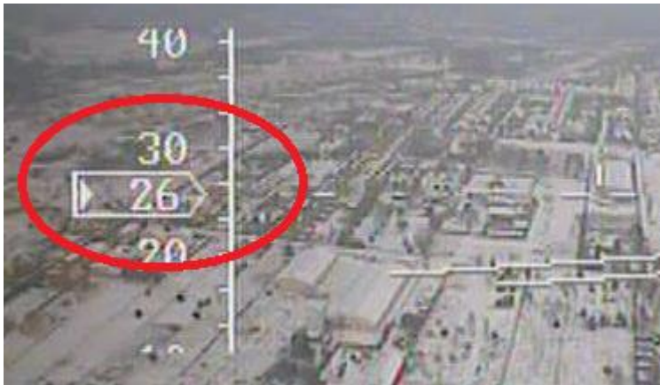
Rysunek 14 Graficzny wskaźnik prędkość modelu. W zależności od ustawień może pokazywać:
