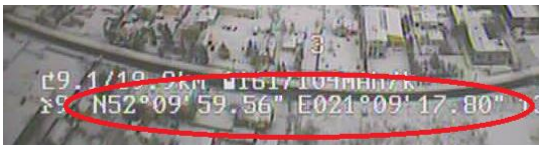
Rysunek 22 Wysokość oraz szerokość geograficzna aktualnego położenia modelu. Do wyboru są 3 typowe sposoby prezentowania współrzędnych geograficznych. Pozwala na odnalezienie zagubionego modelu. UWAGA: Należy wybrać taki sposób prezentacji, jaki mamy używany w swoim urządzeniu nawigacyjnym (Pocket PC z nawigacją, smartfon z GPS itd.), dzięki temu unikniemy niepotrzebnej frustracji i problemów z przeliczaniem formatu współrzędnych w sytuacji awaryjnej.
