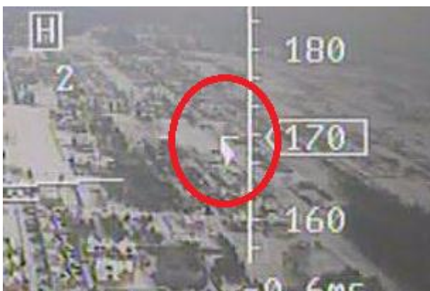
Rysunek 16 Graficzny wskaźnik szybkości wznoszenia i opadania (variometr). Funkcjonuje tylko z barometrycznym czujnikiem wysokości z autopilota. Długość linii oraz kierunek przesunięcia strzałki wskazuje pionową prędkość modelu.
