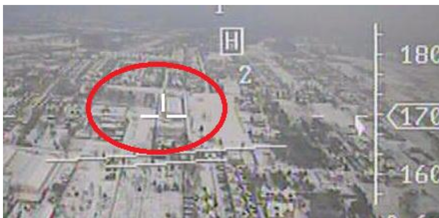
Rysunek 25 Znacznik centralny. Jest to punkt odniesienia dla sztucznego horyzontu, pozwala na szybkie stwierdzenie, czy model ma opuszczony, czy też zadarty do góry dziób
