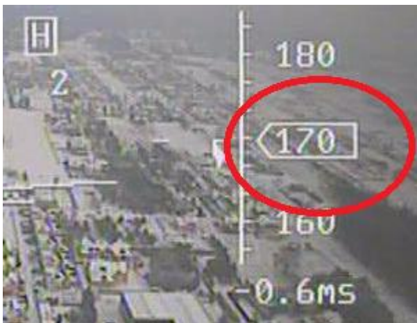
Rysunek 15 Graficzny wskaźnik wysokości względem poziomu lotniska. W zależności od ustawień bazuje na:
