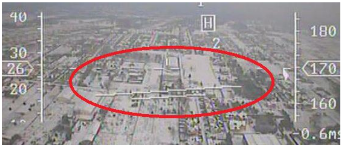
Rysunek 24 sztuczny horyzont. Pokazuje przechył oraz pochycenie modelu. W zależności od ustawień może pokazywać również skalę stopniową pochycenia. Krótsza kreska wskazuje symbolicznie kierunek do ziemi (istotne np. w locie odwróconym lub gdy w kadrze widać samo niebo).
