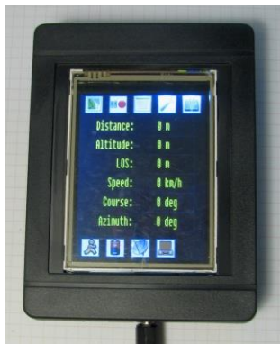
Stacja naziemna z odbiornikiem telemetry, układem diversity z rozgałęziaczem sygnału AV oraz sterownikiem anteny śledzącej.
