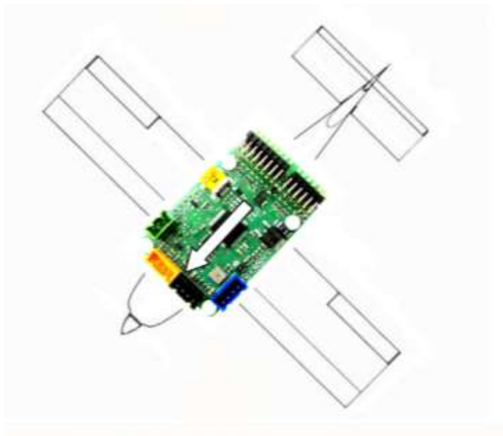
Rysunek 1 Prawidłowe umieszczenie autopilota w osiach modelu
